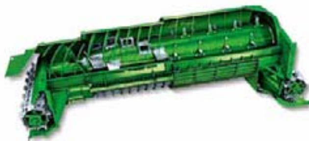
Figur 2. Rotormaskine med langsgående rotor, her vist med én rotor.
