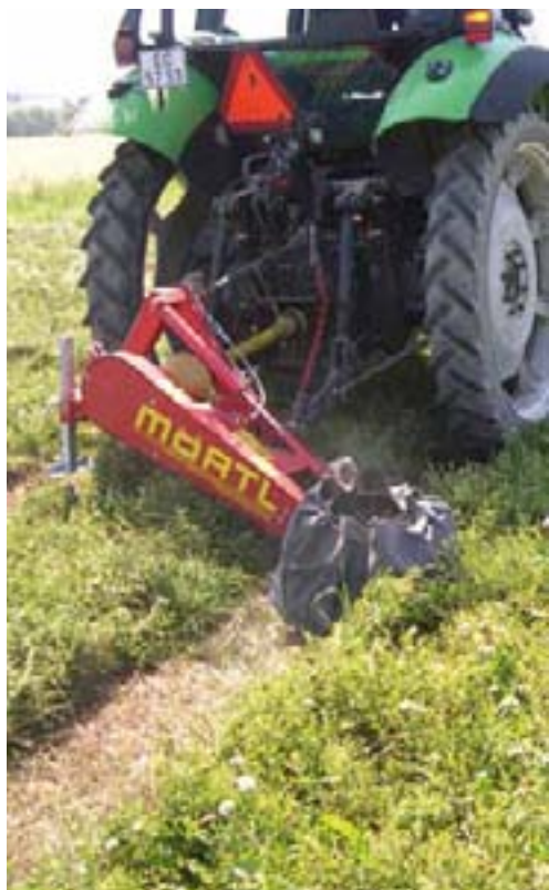
Skårlægning med slåmaskine påmonteret skårruller.
