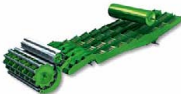
Figur 1. Rystermaskine. Tærskcylinder, bro og halmryster
