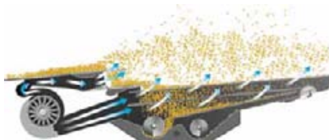
Figur 4. Renseri. På de fleste nyere maskiner er indbygget et faldtrin før soldene, som gør at råvaren bedre kan skilles i avner og frø. Indstillingsmuligheder luftmængde og soldåbning.
