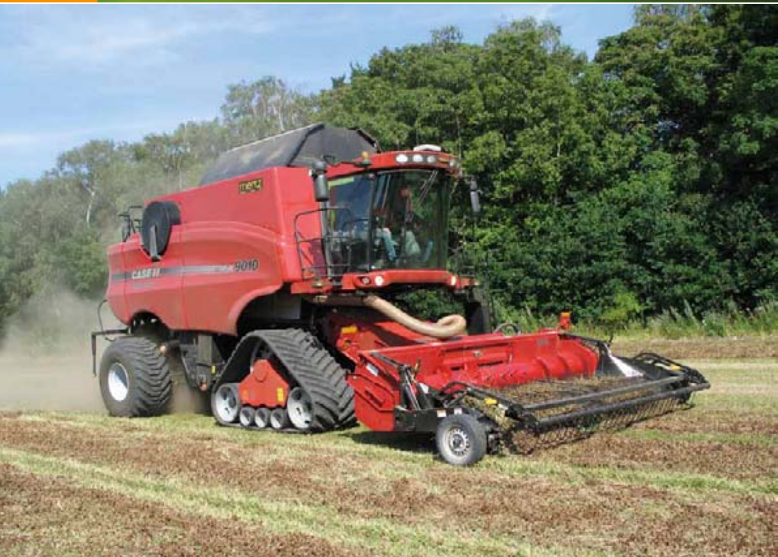
Opsamling af skårlagte afgrøder med pickup sikrer en jævn indføring i mejetærskeren.
