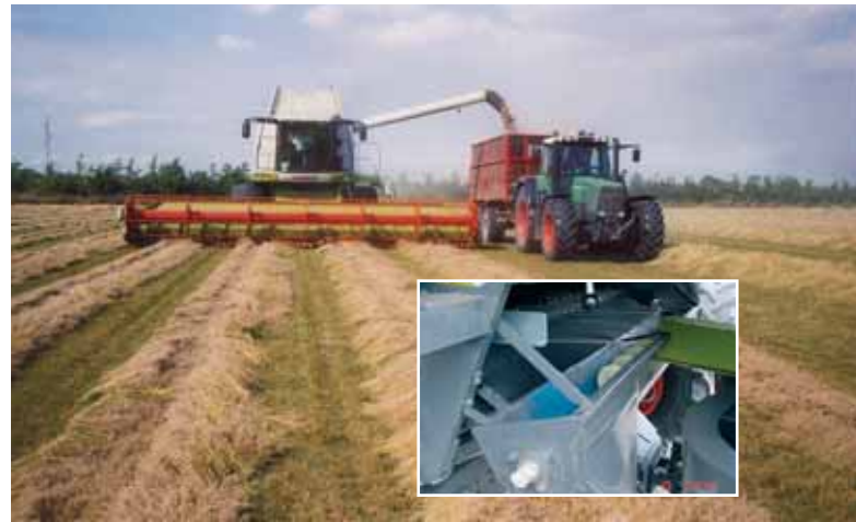
Claas Lexion 560 6 rysters med returterskesystem i engrapgræs Conni. Morten Mark har været yderst tilfreds med maskinen og vurderer, at returterskesystemet meget hurtigt har tjent sig hjem. Rensesvind i marken: 8,23 % Det lille billede viser et udsnit af den påmonterede returtersker.
