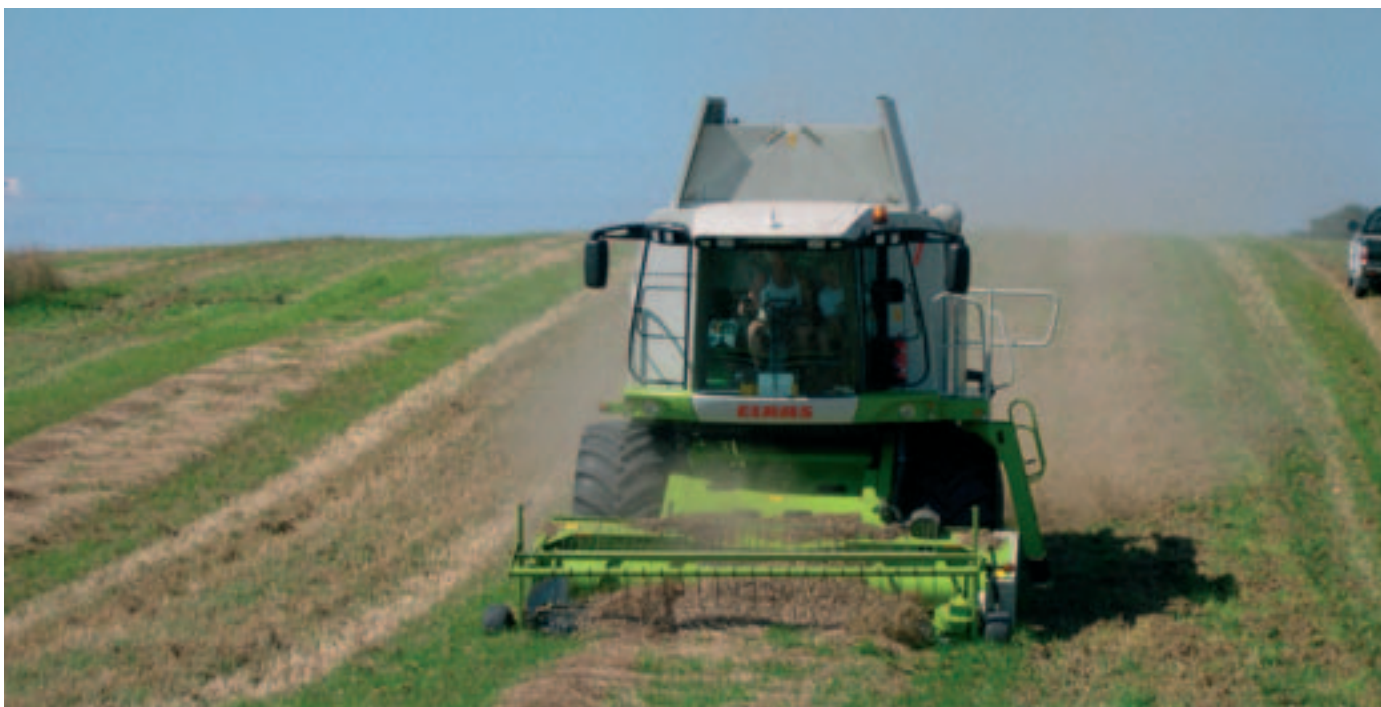
Høst af hundegræs. Gennemgroede skår opsamles uden besvær med pickupbord, her er det Claas "Rakeup bord". Afgrøden er skårlagt med en "MacDon". Fremkørselshastighed: 6 km/t.
