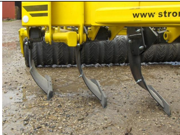
Grubbertanden med sliddele set skråt forfra. Tandspidsen og vingskæret nederst er udskiftelige sliddele. Såudløbene er monteret på en bom, der kan indstilles i højden.
