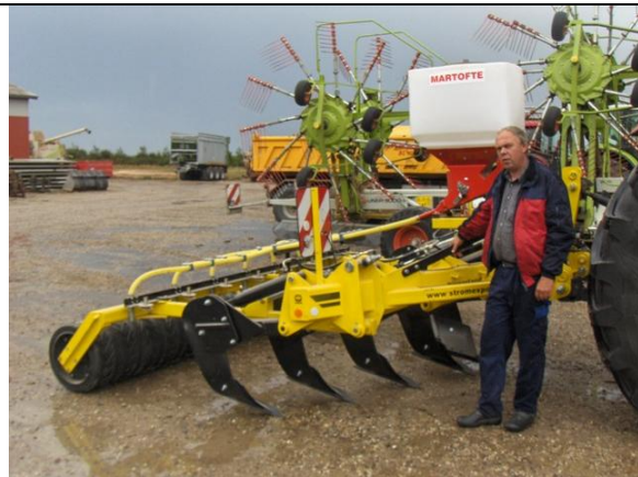
Grubberen Ripperland RO 400 med Turbo-Jet-luftsåmaskine til raps og efterafgrøder. Arbejdsbredden er fire meter. SKS-Maskiner kan også levere en udgave med tre meter arbejdsbredde.
