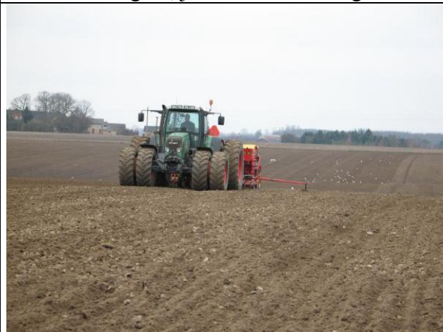
Så er Rapidsåmaskinen i gang. Udlæg sås med de bagerste trakte. De forreste sår vårbyg
