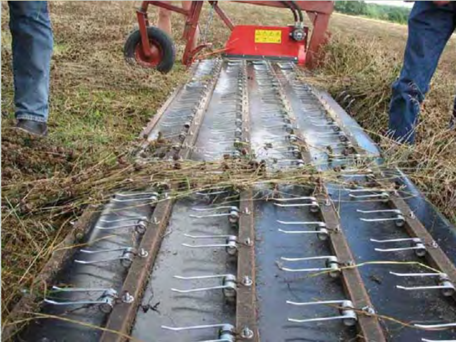
Dekker pickup´en med de bagudrettede fingre
