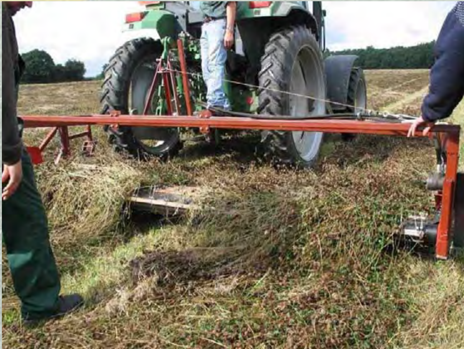
Dekker pickup'en løfter to 7-fods skår af gangen
