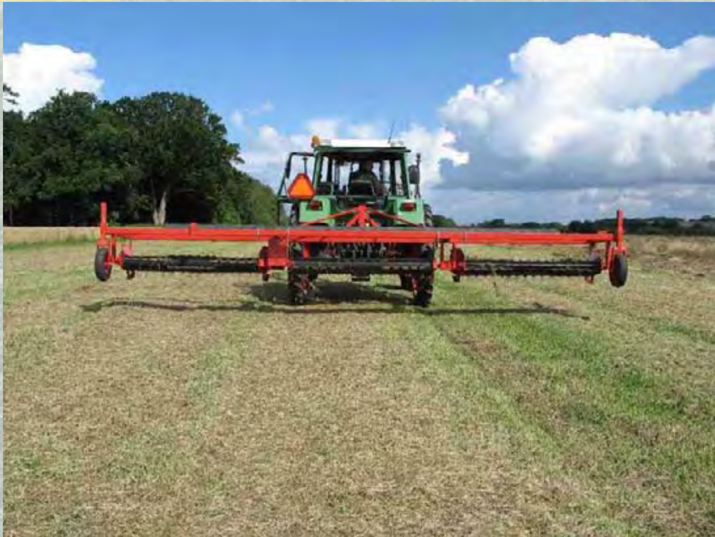
Agerup skårløfteren afmonteret skårbrædder bag og skårbøjler foran
