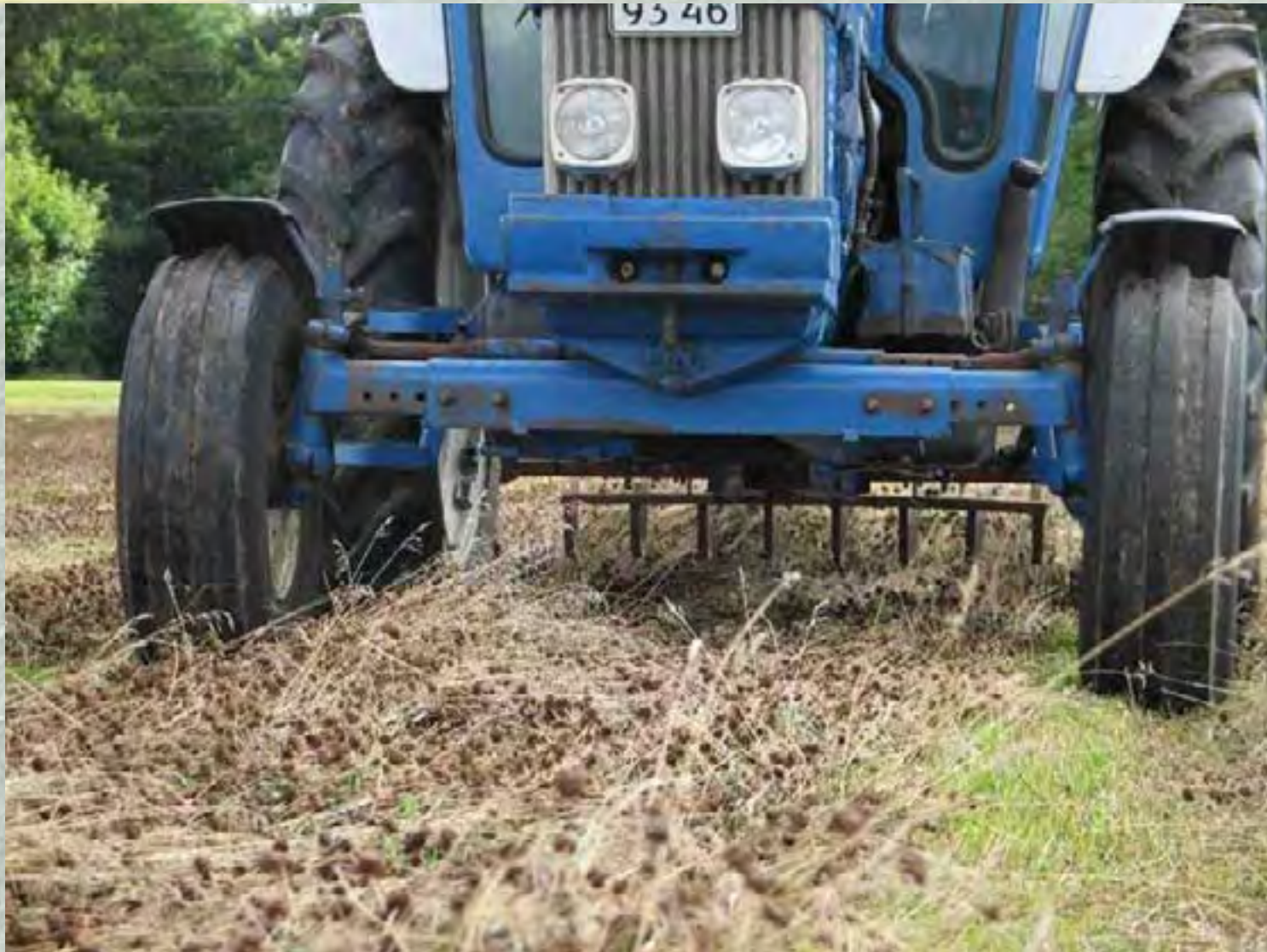
Et kik under traktoren med Pella skårløfteren
