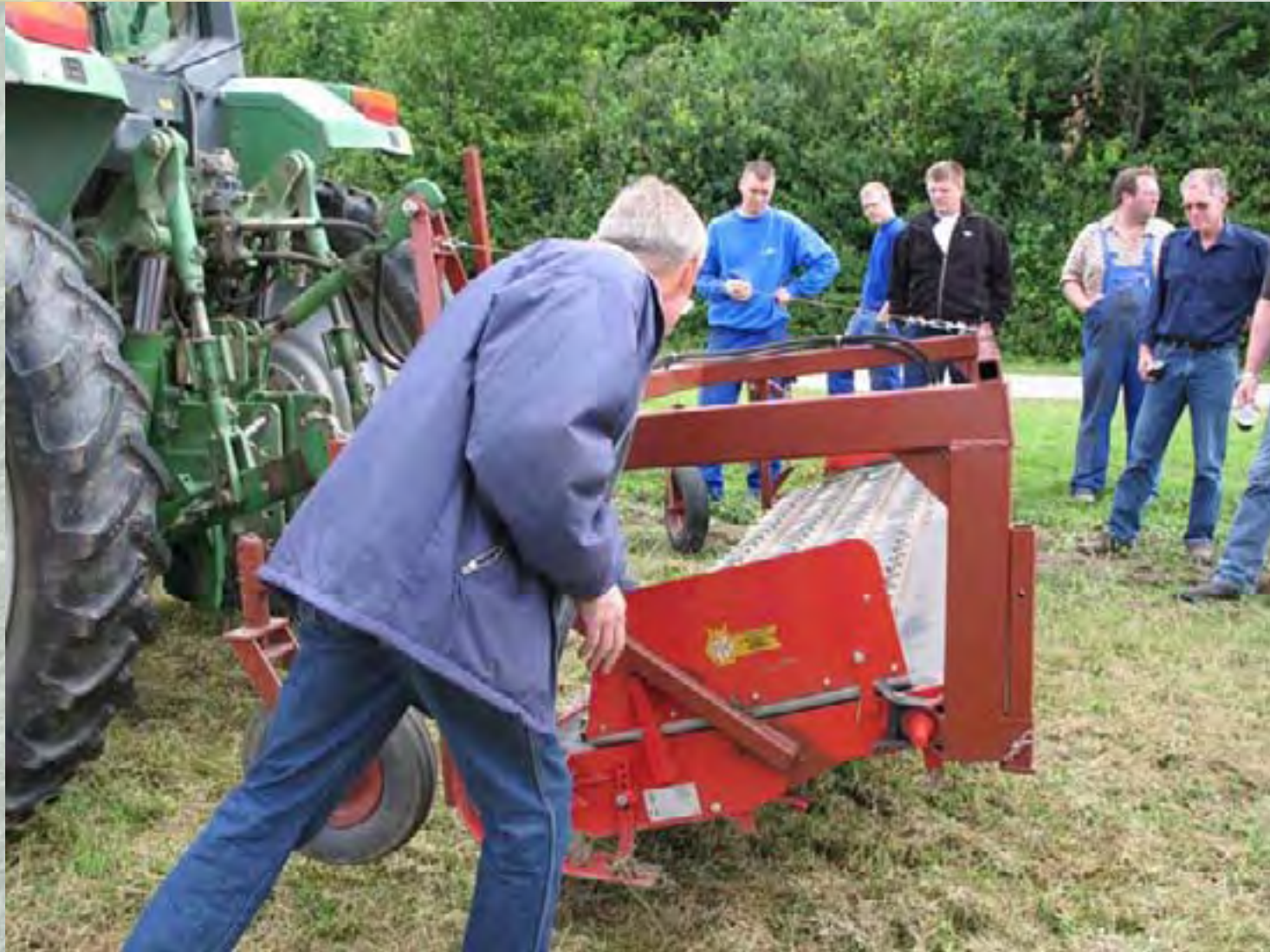
Ombygget Dekker bæltepickup fra Svend Olsen, Ålstrup med bærehjul foran
