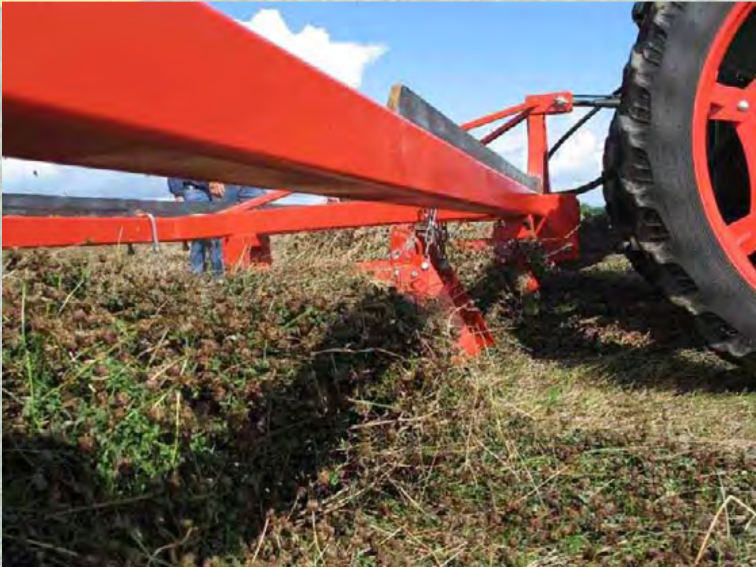
Bæltepickup´er kan have tendens til at kaste lidt med korte hvidkløverstilke foran
