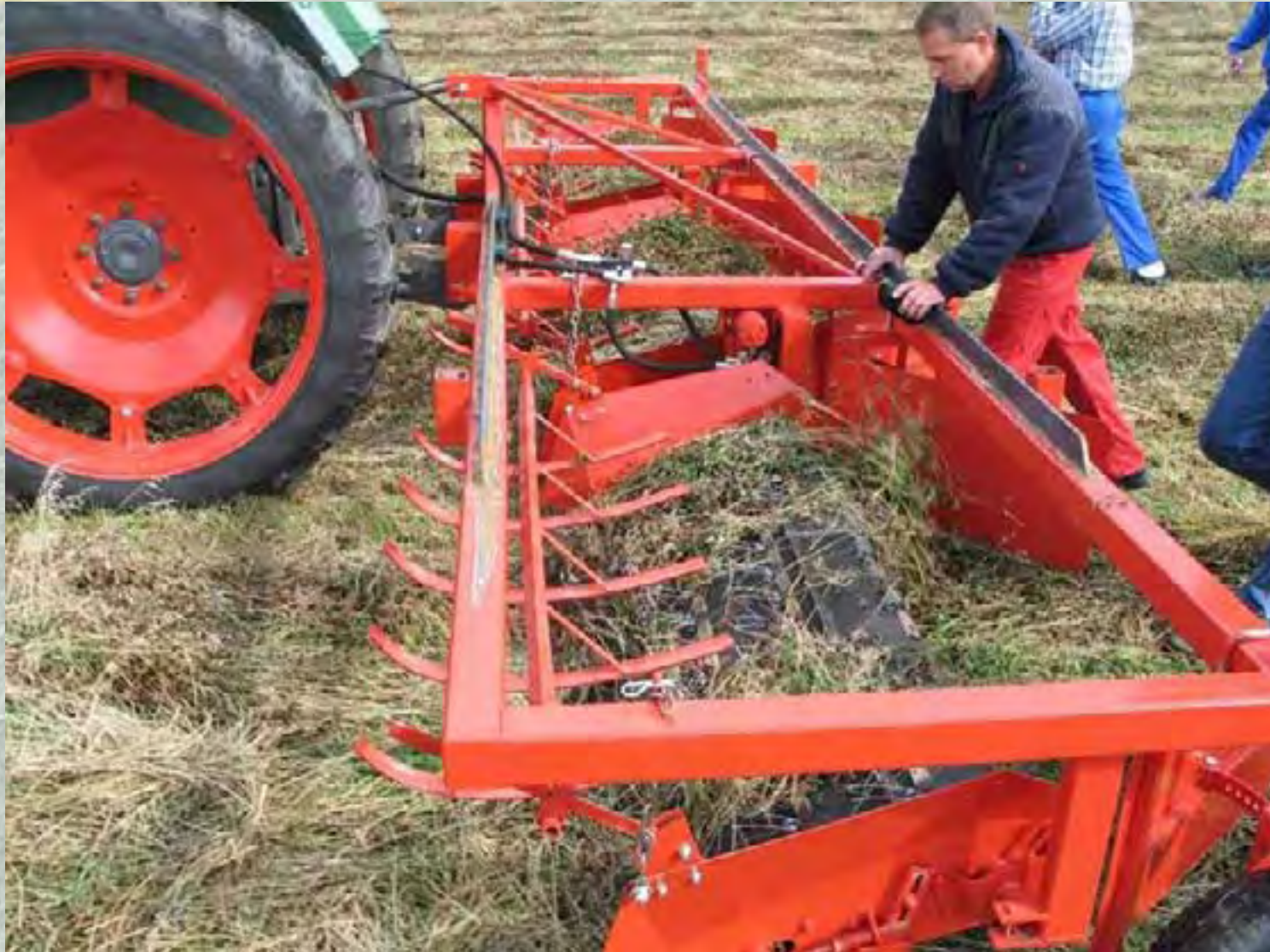
Konstrueret af 3 Farendløse bæltepickup'er, løfter tre 8-fods skår af gangen
