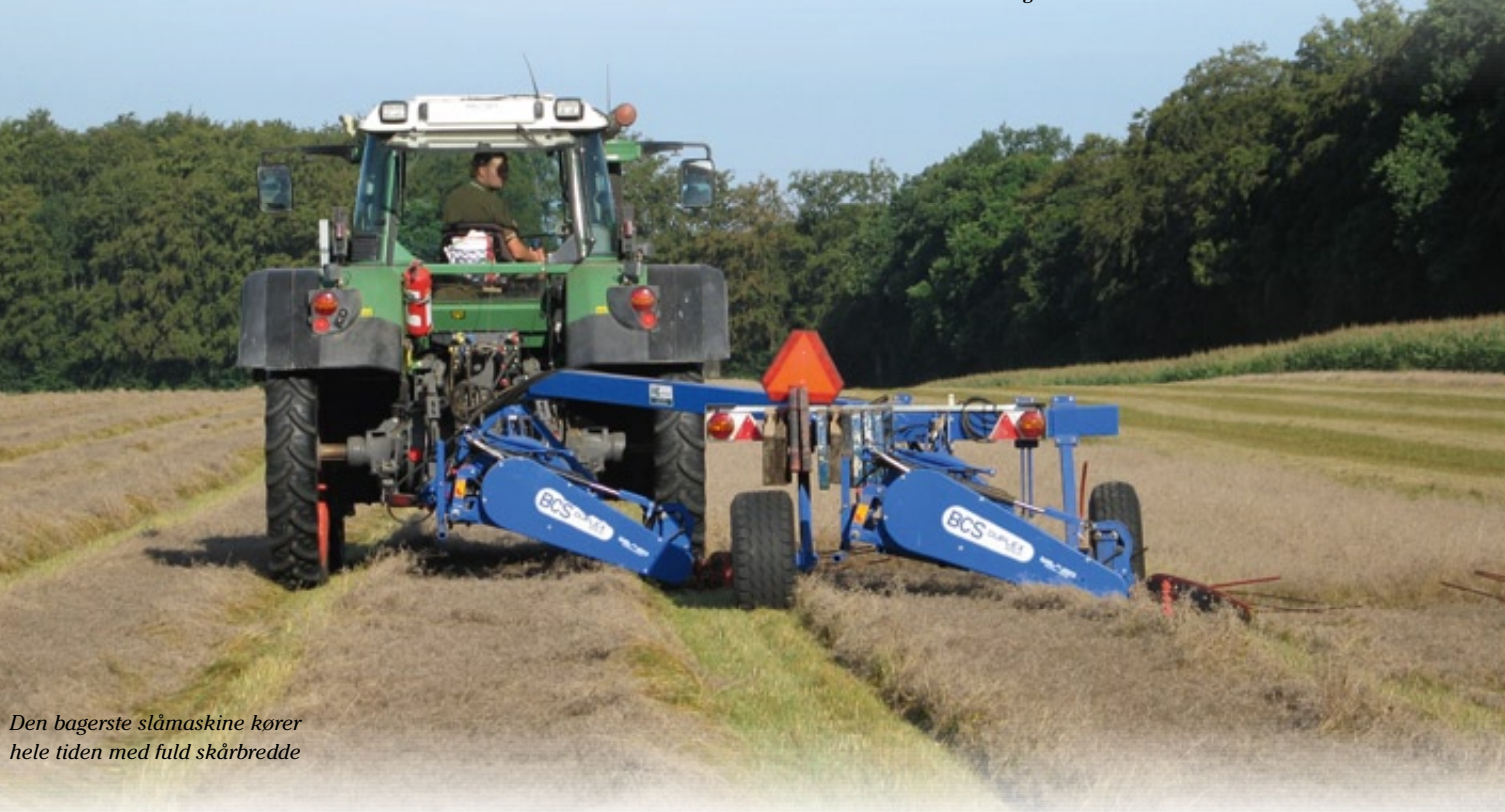
Den bagerste slåmaskine er drevet af en oliemotor
