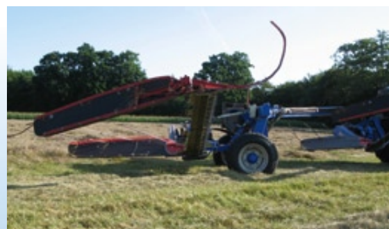
Den bagerste slåmaskine er drevet af en oliemotor
