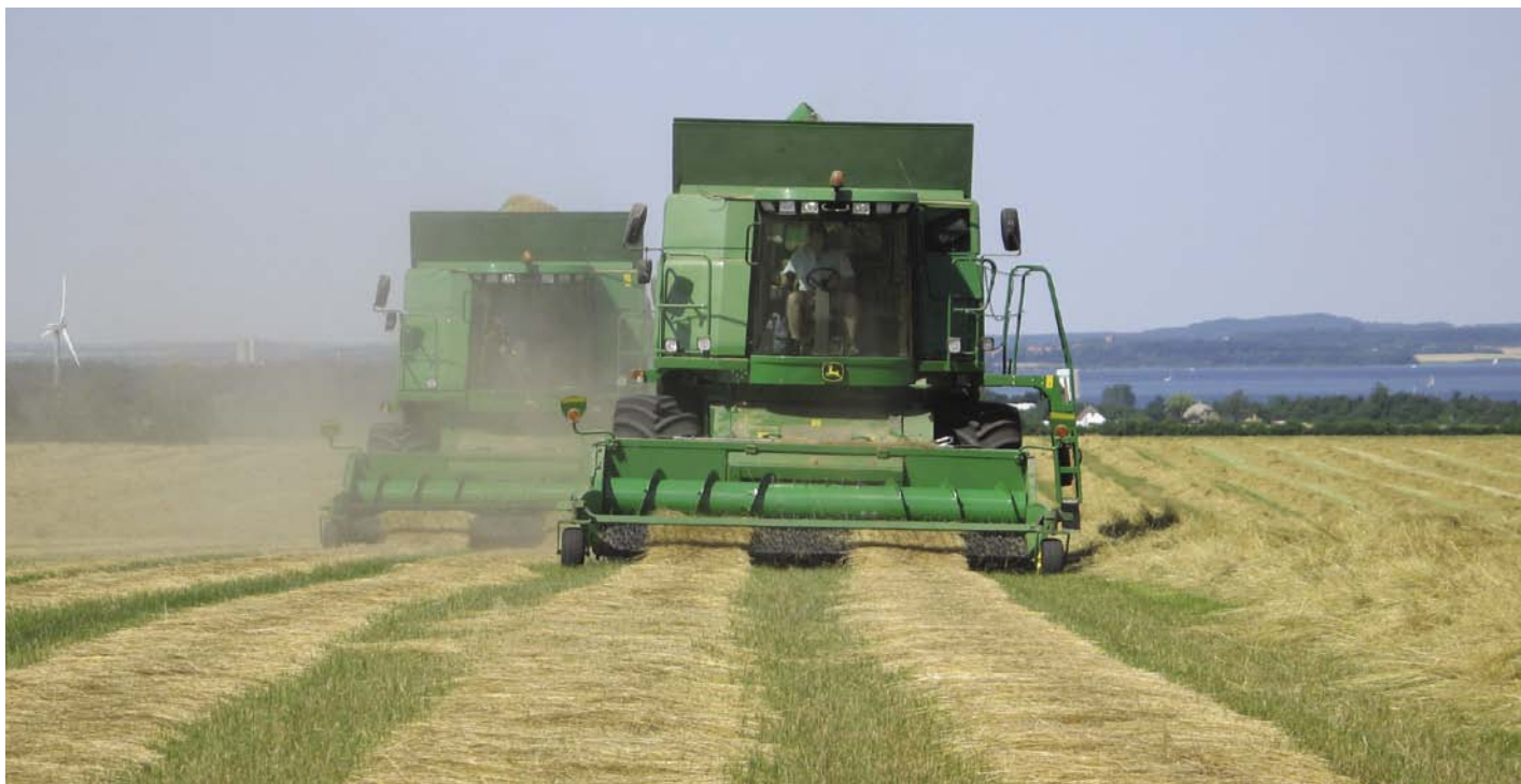
Ideel opsamling af skårlagt frø med pick-up bord
