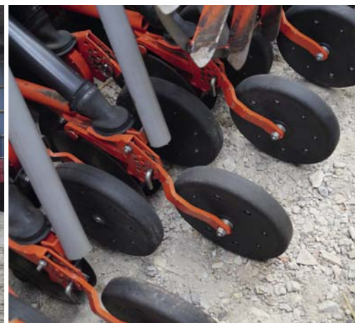
Indretning af såmaskinen med dobbelt fordeling af græsfrøet, så frøet bliver trykket fast til jorden
