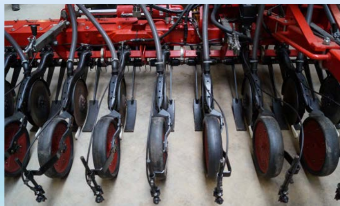
Såskær med trykrulle og placering af flydende gødning oven på rækken
