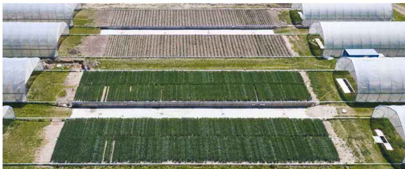
RadiMax-anlægget består af fire grave med v-formet bund. 150 plexiglasrør er installeret i hver grav sammen med et stort antal fugtighedsmålere, der regulerer undervanding fra bunden
