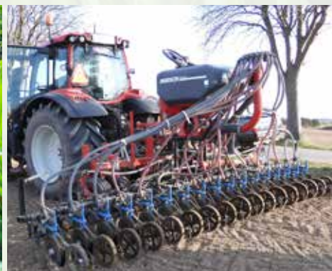
Rækkesåmaskine med aktiv redskabsstyring og placering af aktivt kul + flydende gødning
