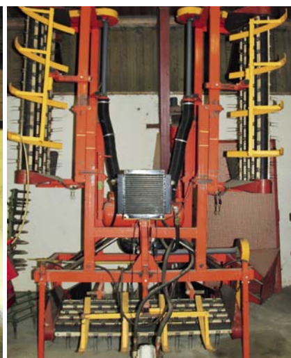
Skårlofteren skår klar, hvis der bliver brug for at løfte hvidkløveren. Bemærk at medbringerne er monteret tættere end normalt
